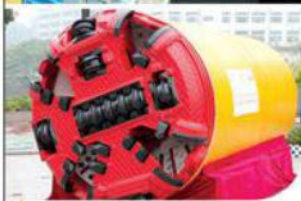
TEM開孔控制技術，配合旋鑽支撐和水沖式壓密方法等建成深孔樁道，有效降低繁忙路段封閉施工的交通擠塞、路旁施工噪音和空氣污染等問題。
